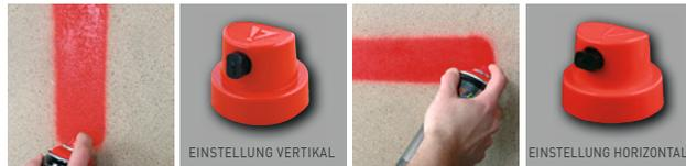
Breites und sauberes Sprühbild, ähnlicher Farbauftrag wie bei einer Spritzpistole. Die Sprühdüse kann variabel eingestellt werden. Bitte beachten Sie die Sprühbewegungen je nach Düsen-einstellung. Sprühabstand zum Objekt ca. 15 cm
